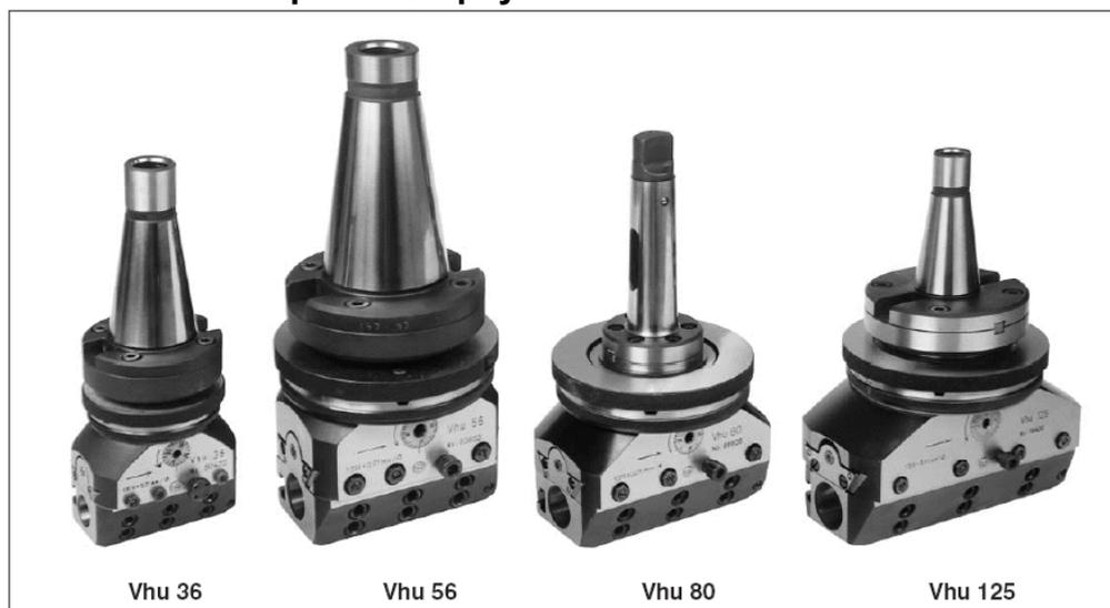
Upínací stopka je nasazena do středícího otvoru příruby (poz.4), která je šesti šrouby (poz.60) přitažena k tělesu hlavy. U Vhu36 a Vhu56 nejsou použita pera (poz.64) pro zachycení kroutícího momentu. U Vhu 36 je průměr příruby 70mm, u ostatních hlav průměr 110mm. Stopka k přírubě je přitažena 4-mi šrouby (poz.1). Šrouby je třeba dotahovat křížem a rovnoměrně, aby se zachovala sousost hlavy s kuzelem. Seznam stopek je uveden v příloze 14.7. na straně 24.
