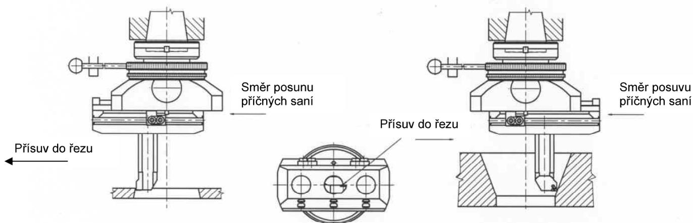
14.4. Řez univerzální vyvrtávací hlavy – typ Vhu 80
